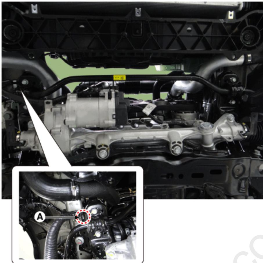
5. Remove the tie rod end nut.
